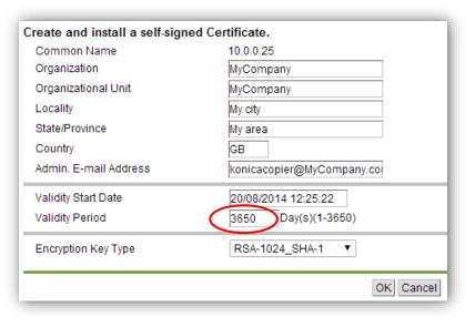
From Security/SSL Setting/Mode using SSL/TLS, select the « Admin. Mode ».
